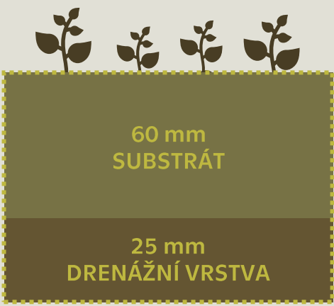
Schematizace vertikálního profilu zelené střechy pro modelování.
